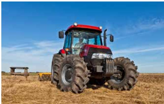
◀ A força de tração máxima é obtida pela tração nas quatro rodas e pelo bloqueio do diferencial.
