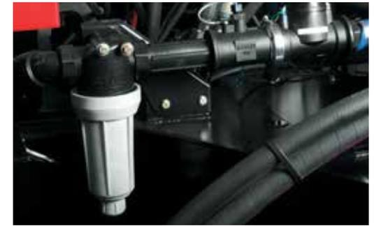
Filtro principal, fluxômetro e válvula
