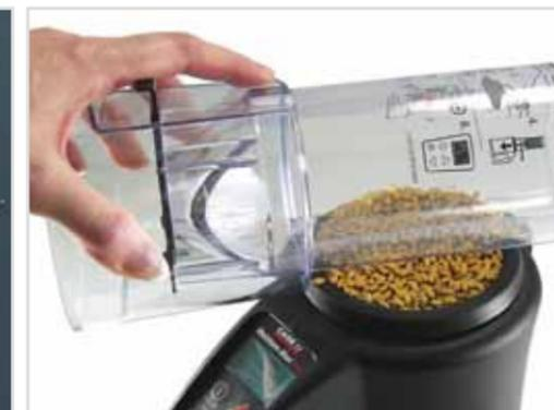
2. Enchimento do equipamento e nivelamento da amostra.
